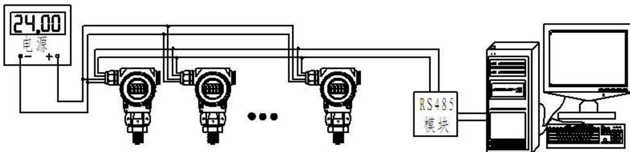
(3) HART 协议型变送器组态系统连接方法:
