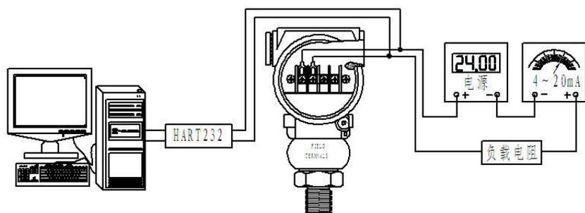
(4) HART 协议型变送器与手操器连接方法:
